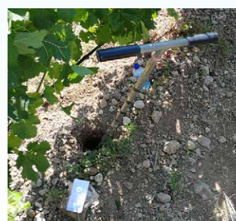
Figure 22 : Tarière permettant le prélèvement des échantillons de sol
