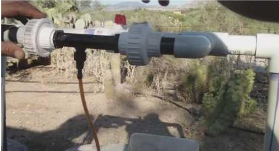
*Système venturi d'injection d'engrais*
