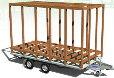
Le module est construit à partir d'une base en ossature bois douglas classe IV d'origine Lozère + pare pluie, certifié FSC.
