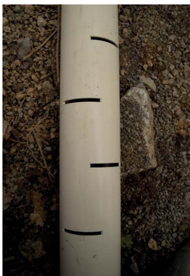
Tuyau de répartition des urines collectées
