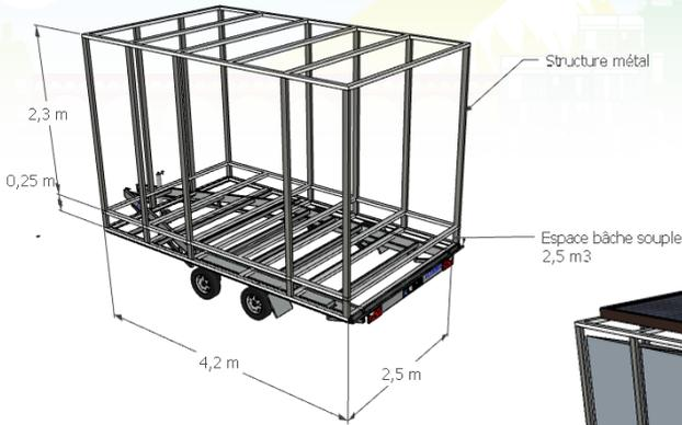
Le module est construit à partir d'une base en tube métalliques
