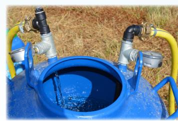
Figure 24 : Cuve de fertilisation en vidange
