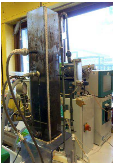
Figure 7 : Pilote de nitrification des urines avec bioréacteur à membranes
