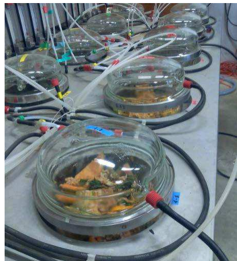
Figure 5 : Dégradation de la matière organique : suivi des dégagements gazeux
