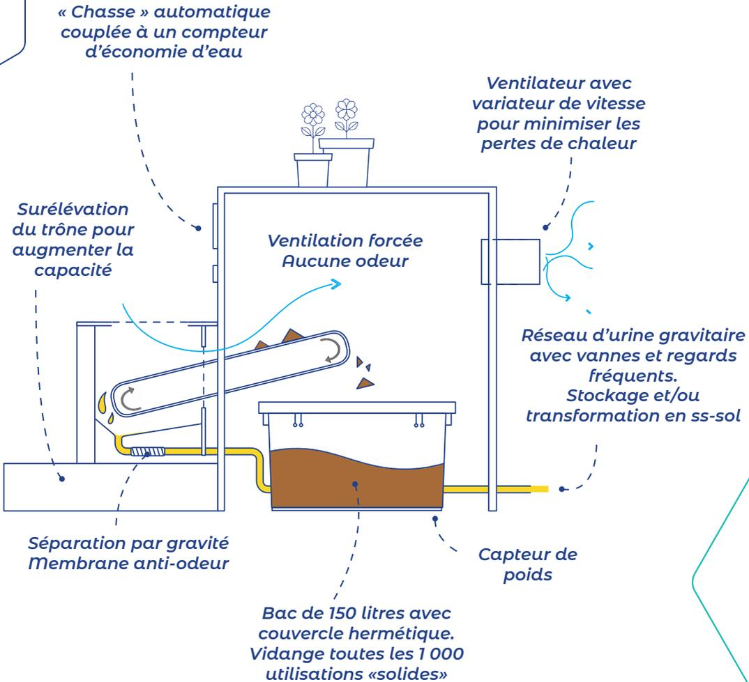
**Système "Retrofit" => rétablissement d'un trône à chasse très simple**
