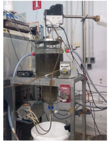
Figure 3 : Pilote pour la récupération du phosphore des effluents d'élevage
