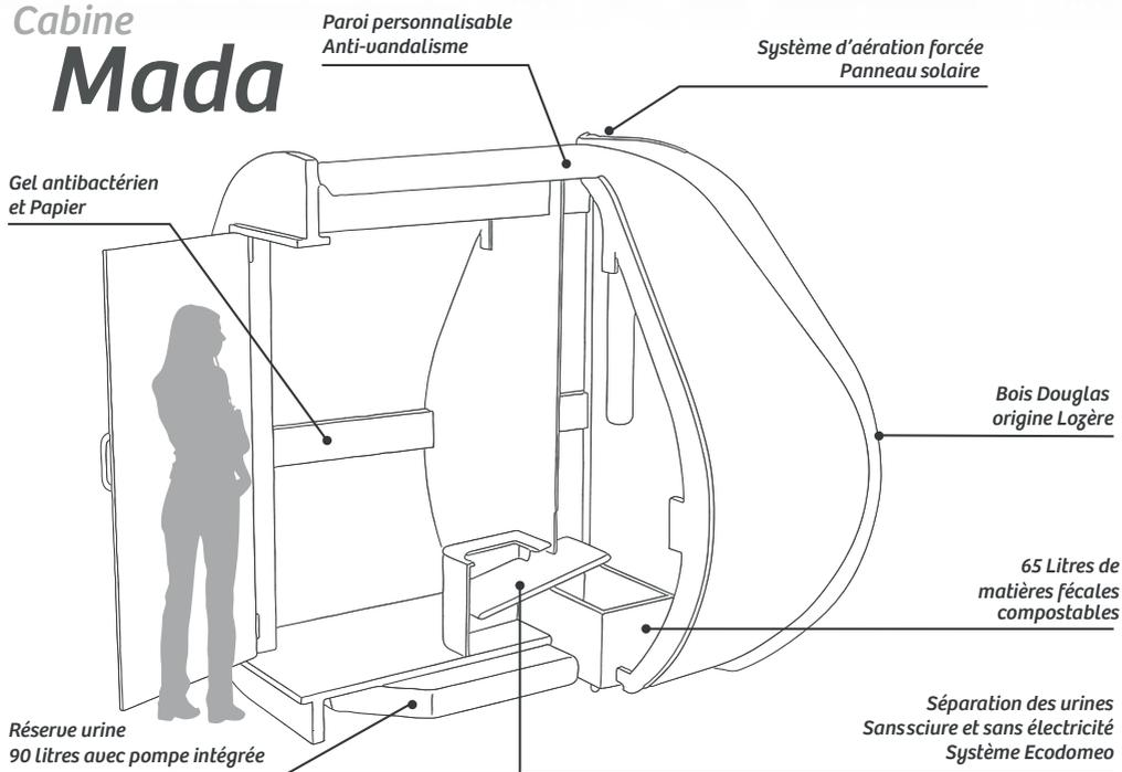
**Hygiénique** : Pas de sciure, pas d'odeurs grâce à la ventilation forcée. Les surfaces lisses en composite renforcent la sensation de propreté
