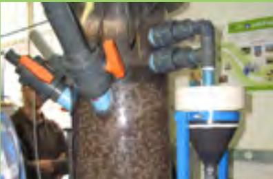
L'urine contient la majeure partie des éléments à grande valeur agronomique rejetés par notre corps. La nitrification suivie d'une distillation permet de concentrer tous ces nutriments dans un faible volume et ainsi réduire les coûts liés au transport.
